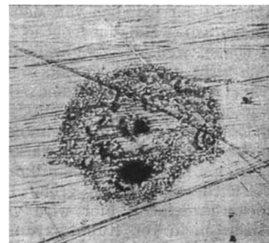
Abb. 10. Mittelstark versilbertes Echtsilberblech. Entstehende Ausblühung nach 12stündigem Liegenlassen; auskristallisierte Salze und Reste des Poliermittels (großer schwarzer Fleck unten). \times 192 .
